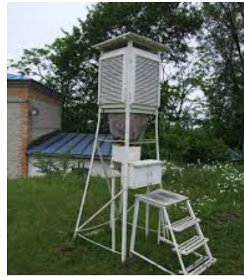
Havanın temperaturunun ölçülməsi üçün istifadə edilən qurğu
