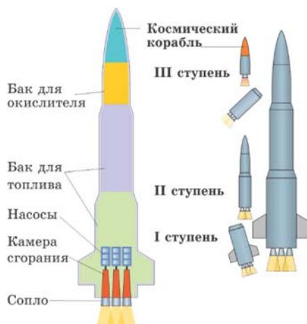
рис.1. Схема ракетносителя и трехступенчатого ракетносителя
