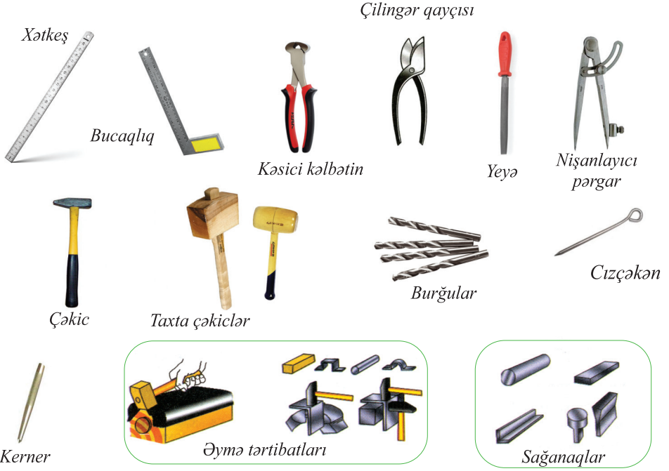
Şəkil 3. Metalın emalı üçün alət və tərtibatlar
