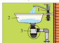
Рис. 1. Устройство умывальника: 1 – смеситель; 2 – раковина; 3 – сифон
