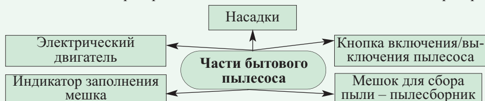
Рис. 2. Устройство бытового пылесоса
