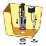
Рис. 6. Установка арматуры в сливной бачок
