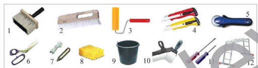
Рис. 1. Инструменты и приспособления для обоевых работ. 1 – кисть для нанесения клея; 2 – щетка для разглаживания обоев; 3 – валик; 4 – нож канцелярский для нарезки обоев; 5 – дисковый нож для подрезки выложенных обоев у плинтусов и наличников; 6 – ножницы для нарезки полос обоев; 7 – отвес для контроля вертикальности обоев; 8 – губка для очистки поверхности материалов; 9 – ведро для клея и воды; 10 – шпатель; 11 – отвертка для снятия верхней крышки выключателя и розетки; 12 – передвижная помост
