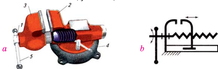
Şək. 2. Mənəgənə: a – mənəgənənin quruluşu (1 – vint; 2 – hərəkətsiz dodaq; 3 – hərəkətli dodaq; 4 – dayaq çatısı; 5 – dəstək (ling)); b – mənəgənənin sxemi
