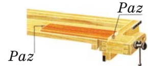
Şək. 6. Səthin rəndələnmə üçün bərkidilməsi
