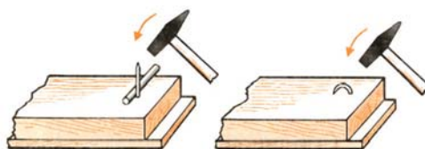
Şək. 2. Mismarın əyilməsi və vurulması
