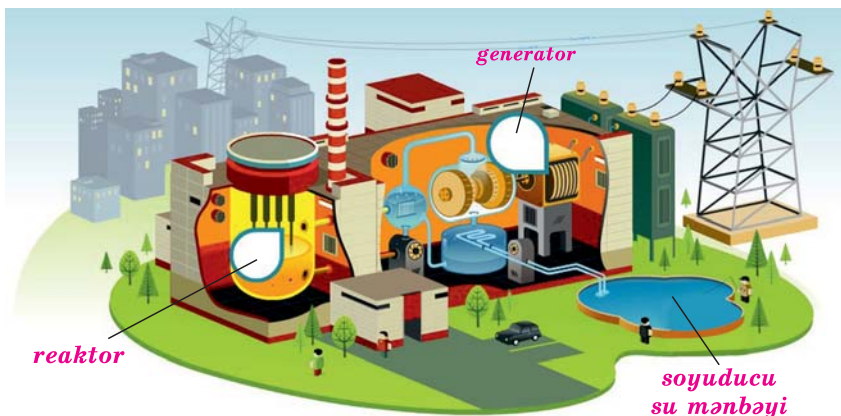
Şəkl. 3. Elektrik enerjisinin AES-də alınması
