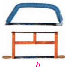
Şək. 2. Mişarların növləri: a – bıçqılar; b – yaylı mişarlar; c – diskli elektrik mişarı
