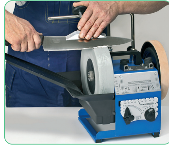
Şəkil 2. Bıçağın elektrik itiləmə dəzgahında itilənməsi
