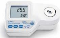
Şəkil 1.10. Şirədə şəkərliyi təyin edən müasir refraktometr
