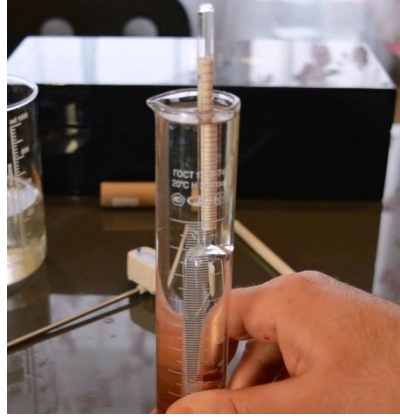
Şəkil 1.9. Ariometr vasitəsilə şəkərliyin təyini
