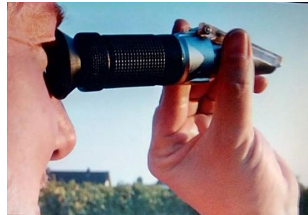
Şəkil 1.3. Sahədə mobil refraktometrlə üzümün yetişməsinə nəzarət edilməsi
