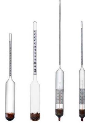
Şəkil 1.9. Ariometr vasitəsilə şəkərliyin təyini
